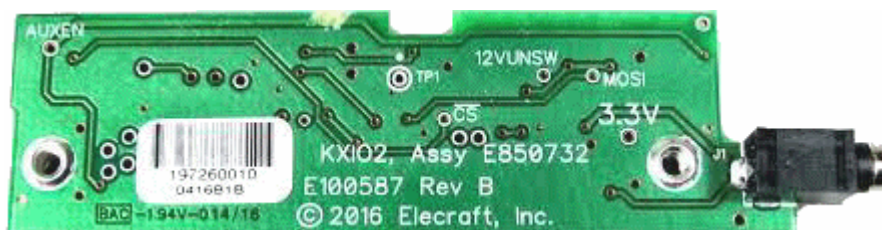
KXI02 Echtzeit Uhr und Kontroll Interface
